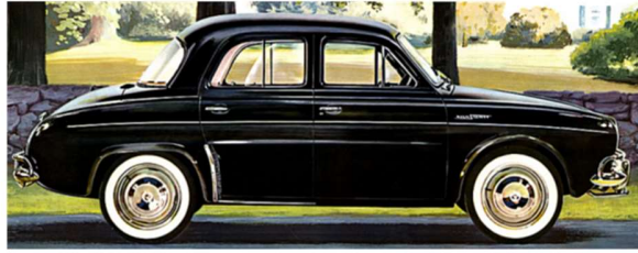
Henney Kilowatt (ABD), 1959. 36-volt sistem, 18 ad. 2-volt batarya ile güçlendiriliyor. 7-HP elektrik motoru, 65 km menzil, maks hızda 65 km/h
